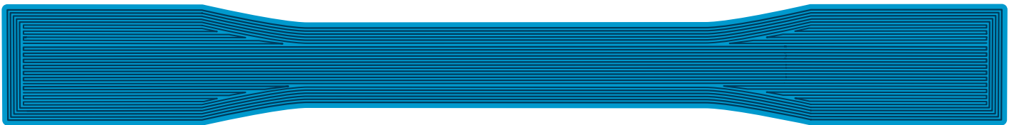
Figura 6: trayectorias de herramienta del cupón de tensión D638 con trayectorias de herramienta unidireccionales dentro de la región reducida.
