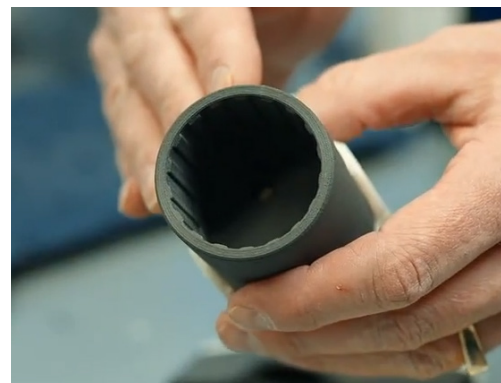
El zócalo de la herramienta manual impresa en 3D, que muestra las estrías y el acabado de superficie impresa liso.
