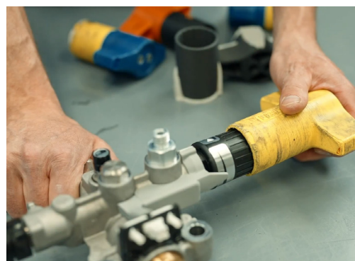
Se muestra la antigua herramienta manual ABS (amarilla), que activa la perilla de ajuste en un dispositivo de control de presión.
