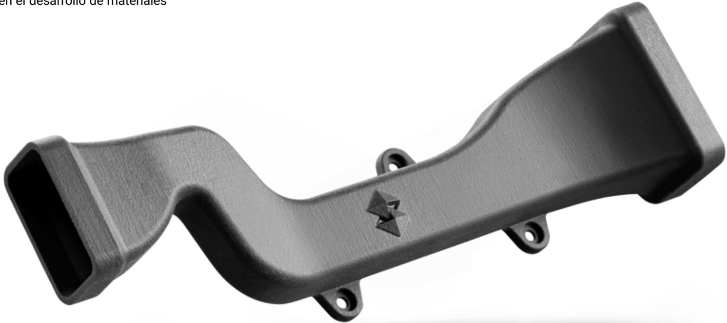
Este conducto de aire forma parte de un sistema HVAC automotriz, impreso con tecnología SAF™. Tradicionalmente, una pieza como esta podría moldearse en dos mitades y ensamblarse. Con la tecnología SAF, las mitades se pueden producir como una sola pieza, lo que reduce el ensamblaje posterior al proceso y los puntos de falla.
